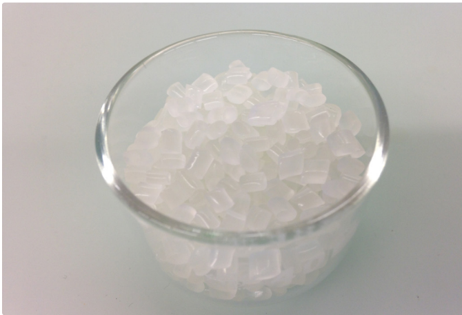
Granuläres Poly- \alpha -olefin: Grundbestandteil reaktiver PO-Schmelzklebstoffe
