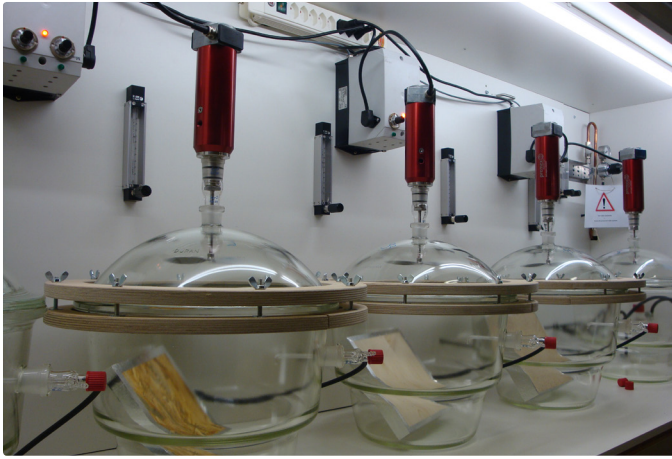
Emissionsprüfkammer aus Glas mit einem Volumen von 23 L
