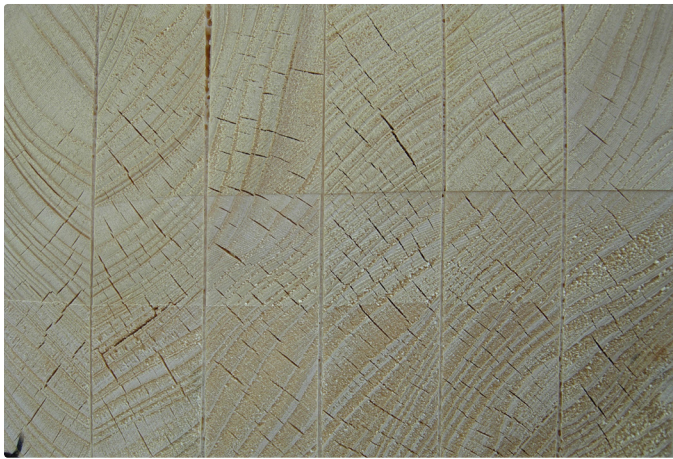
Prüfkörper nach Bestimmung der Delaminierungsbeständigkeit nach EN 302-2
