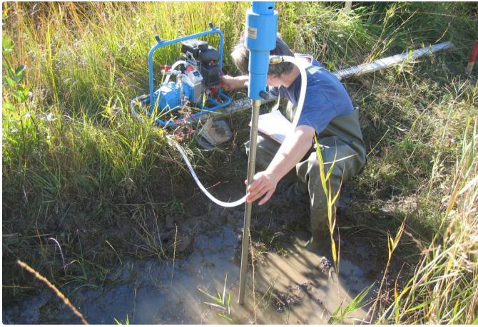
Sondierung mit der leichten pneumatischen Rammsonde
