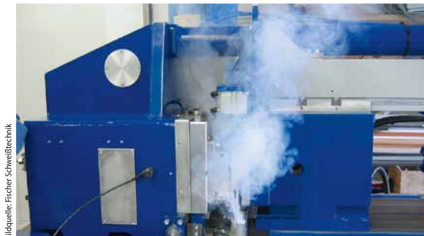
Wenn die Holzschweißmaschine loslegt, fallen keine Späne – dafür steigt Rauch auf und in Sekundenschnelle sind die Holzbretter verbunden
