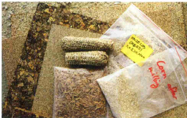
Veredelung von Abfällen: In einem komplexen Verfahren werden Rohmaterialien wie Maiskolben oder Reisbülßen (Bild links) zermahlen und in widerstandsfähige Bauplatten für den preisgünstigen Hausbau in Nigeria gepresst.
